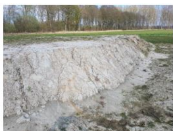
Figuur 7: Leemwand W3. Hier trad meer erosie op dan op de andere locaties en in de loop van het seizoen raakte deze wand ook grotendeels begroeid.
