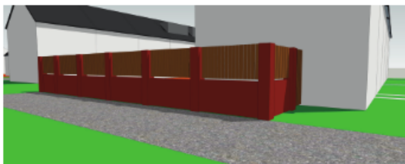
Metselwerk gecombineerd met verticaal houtwerk
