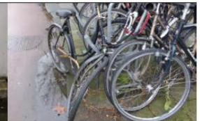
Voorvork gebroken (+ krom wiel)
