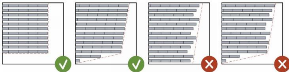
Figuur 2. Het uitlijnen van panelenrijen langs zichtbare randen.
