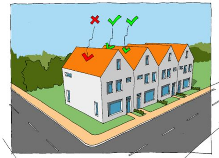
Figuur 3 Zonnepanelen op hellende daken
