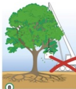
8 Werk met bouw materieel waar mogelijk buiten de kroonprojectie en gebruik aan de omgeving aangepast materieel. Hiermee wordt onnodige schade aan de boom voorkomen.
