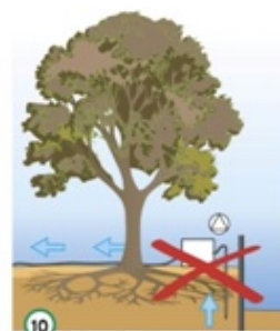
10 Wordt er in de periode van april tot en met oktober gebronnend, plaats dan altijd bodemvochtsensoren die wekelijks worden uitgelezen. Hiermee kan tijdig worden ingegrepen wanneer bomen dreigen te verdrogen. Beter is om te bronnen buiten het groeiseizoen.
