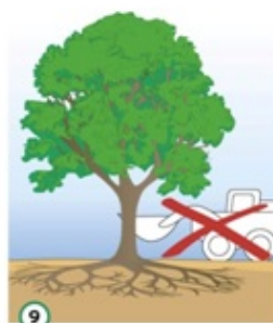
9 Rijd nooit met zwaar materieel over de wortelkruis. Dit leidt tot verdichting en verstikking van de bodem met wortelsterfte als gevolg. Is dit onvermijdelijk, plaats dan sloopshuiden op een bed van grof zand.
