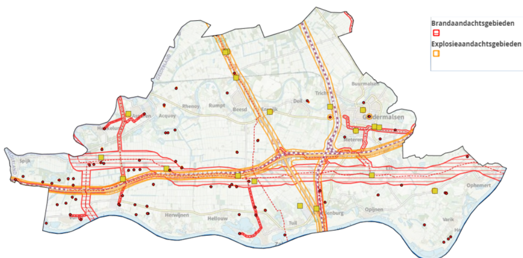
Figuur 5. Relevante risicobronnen met een voorlopige indicatie van de brand- en explosieaandachtsgebieden
