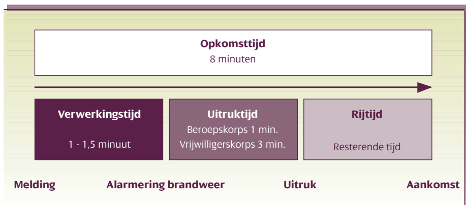
Figuur 1. Opkomsttijd (met de aannames uit de Handleiding Brandweezorg over de 'bouwstenen' van de opkomsttijd)
