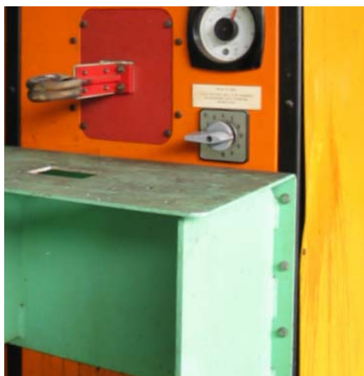
Figuur 7 Een te renoveren inductieverwarmer met open spiraal.
