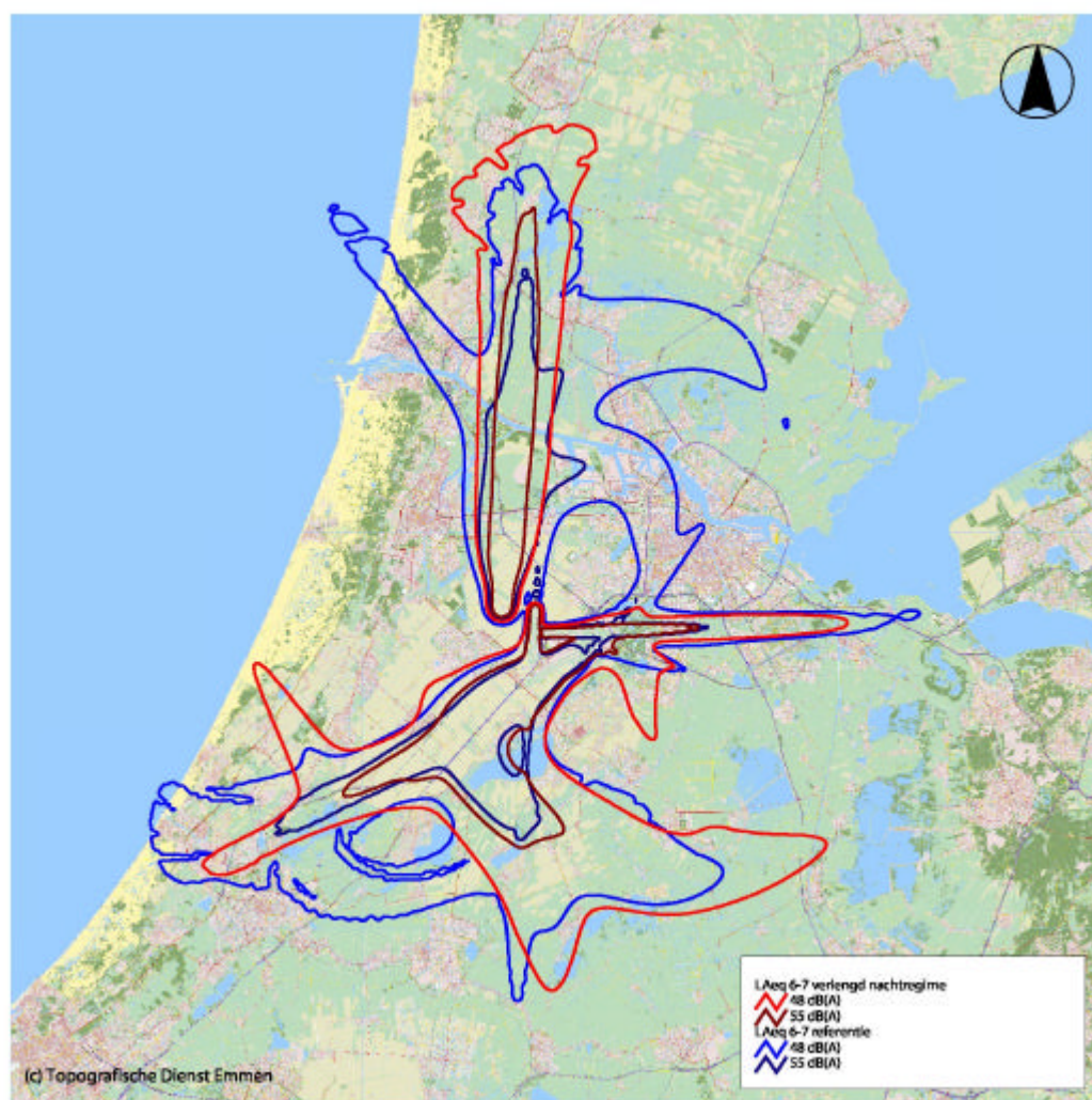
Figuur C. 4: 48 en 55 dB(A) contouren van L Aeq 6:00 – 7:00 uur voor de referentiesituatie en de situatie met verlengd nachtregime
