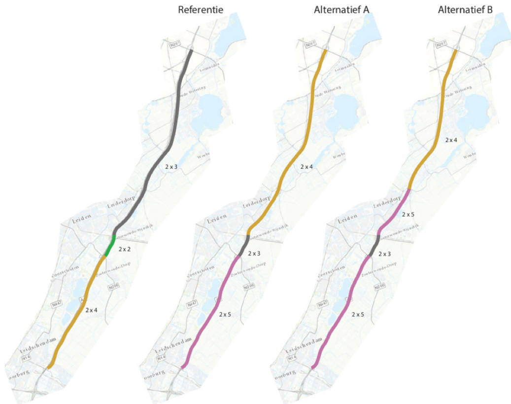
Figuur 3.2: Weergave aantal rijstroken op de hoofdrijbaan in de referentie en in de alternatieven A en B. Het aantal rijstroken op de parallelrijbaan (bij Leiden/Leiderdorp) is niet gevisualiseerd (dit wijzigt niet t.o.v. de referentie).
