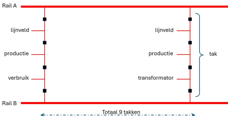
Figuur 9: Vereenvoudigde schematische weergave opbouw station EHO380
