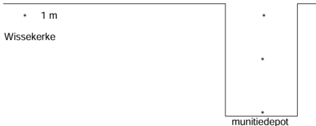
Figuur 2: Schematische weergave van de meetlocaties in de waterkolom. Bij het munitiedepot nabij Zierikzee is gemeten op drie dieptes: één meter boven de bodem, halverwege de waterkolom en één meter onder het wateroppervlak. Bij referentiepunt Wissenkerke is uitsluitend gemeten op één meter onder het wateroppervlak.
