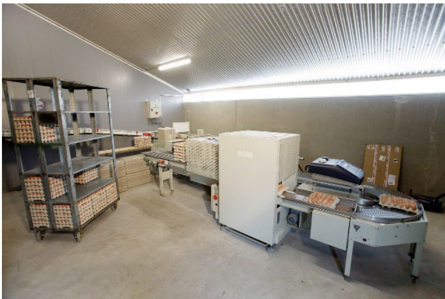
Figuur 2.12 Eier-inpaklokaal en eier-inpakmachine (Bron: Brandweeracademie)
