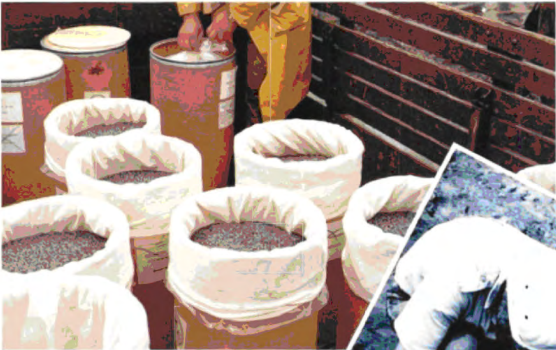
Transportcontainers met kruiïkorrels. De korrels worden verpakt in achter-eenvolgens anti-statische stof, plastic en kartonnen container.
