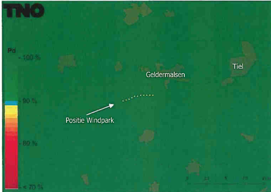
Figuur 7 Detectiekans van het primaire verkeersleidingsradanetwerk op 1000 voet boven het bouwplan nadat dit is gerealiseerd. De locatie van de nieuwe windturbines is aangegeven met gele stippen.
