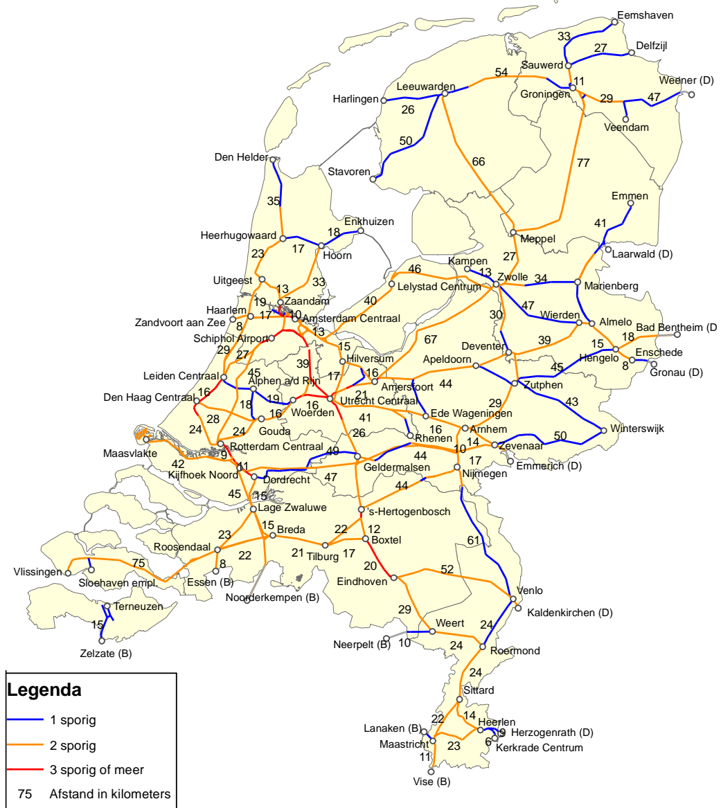
Figuur A.1: Algemene overzichtskaart met netwerkconfiguratie van het hoofdspoor (Situatie januari 2019). Uit: ProRail. Netverklaring 2019 . Version 1.6. Sep. 2019, Bijlage 1.
