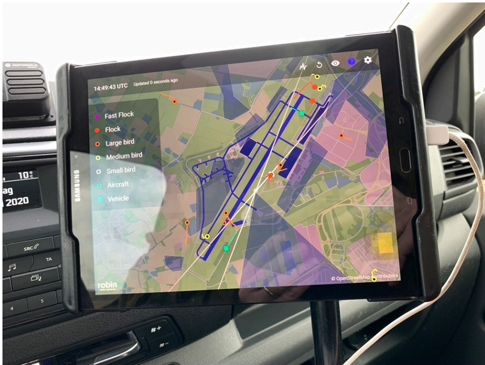
Radardisplay (3D Flex) in de bird control wagen op Vliegbasis/Airport Eindhoven. De gekleurde 'kikkervisjes' zijn vogeltracks, de kleuren worden verklaard in de legenda. De blauwe vlakken zijn blinde vlekken.
