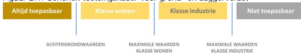
Figuur 2.1. Generiek toetsingskader voor grond- en baggerverzet
