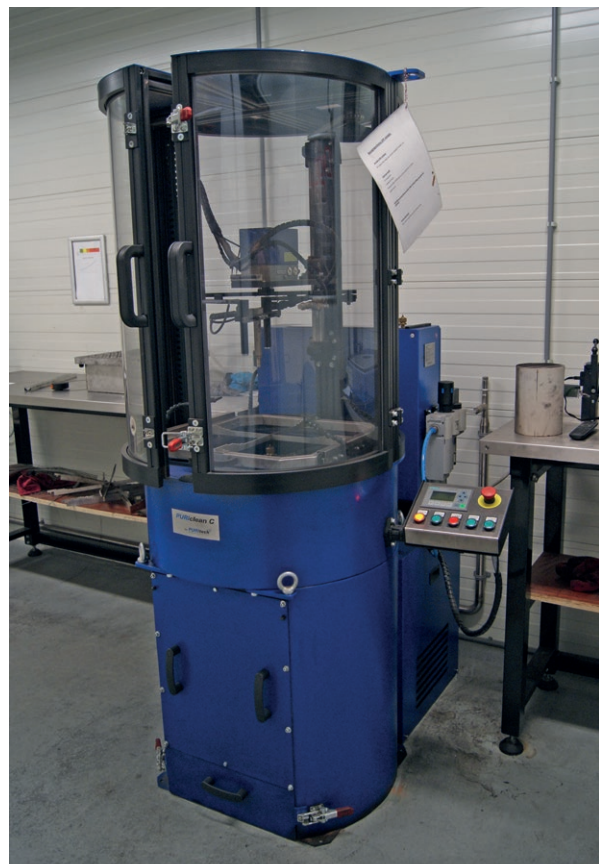
Figuur 8. Bij een oven-reiniging wordt een DPF voor enkele uren in een oven (boven) geplaatst. Na verblijf in de oven worden as uit het filter geblazen (onder) (foto: TNO bij Digicar Engineering).
