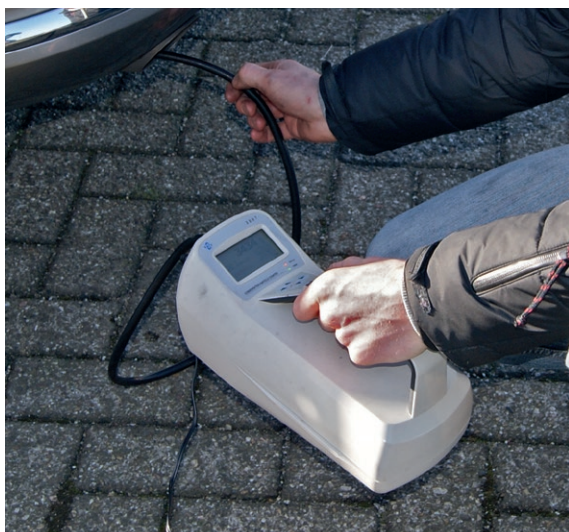
Figuur 15. Naast de conventionele roetmeting is van de 213 dieselvoertuigen het aantal deeltjes (Particle Number of PN) in de uitlaatgassen gemeten met behulp van een deeltjesteller. De monsternameslang wordt in de uitlaat gehouden terwijl de warme motor stationair draait (links). Het apparaat geeft op het display het aantal deeltjes per cm 3 aan ('10' op de rechterfoto) (foto: TNO).
