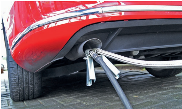
Figuur 13. De roeuitstoot van dieselveertuigen kan tijdens de APK worden vastgesteld met behulp van een rookmeter. Voor moderne dieselauto's mag men echter volstaan met het uitlezen van het OBD-systeem (foto: TNO).
