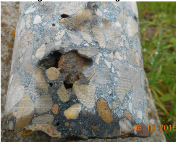
Afbeelding 1.3. Luchtinsluitingen kern X8-onder
