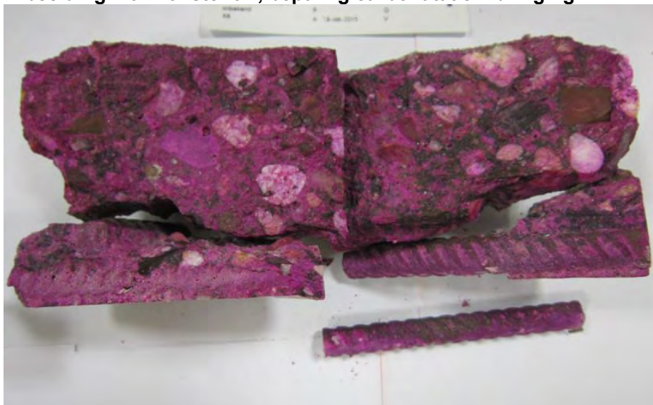
Afbeelding 1.6. Monster 9B, bepaling carbonatatie indringing
