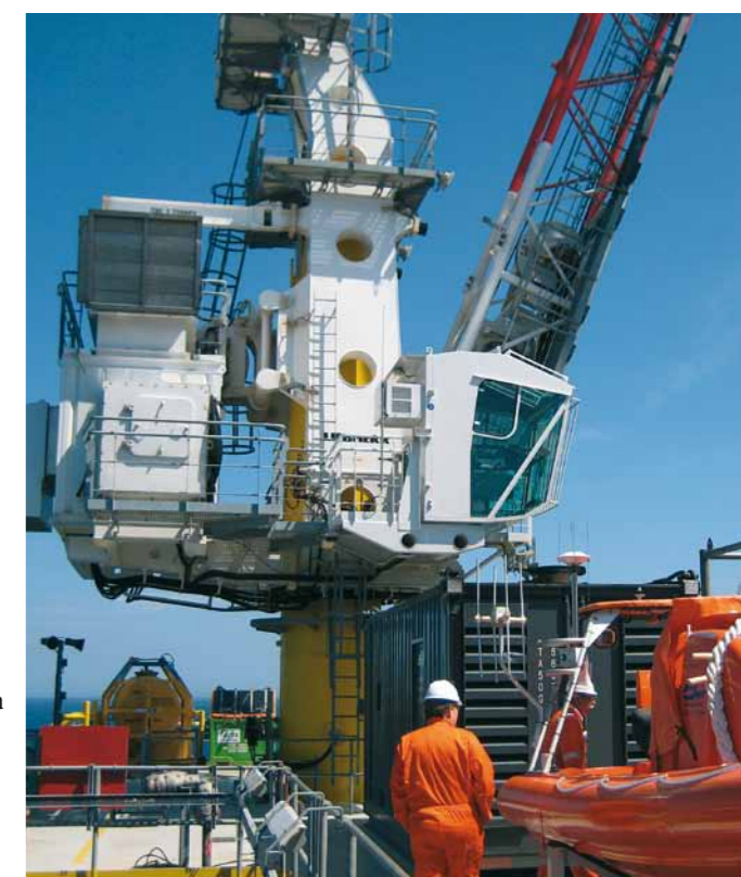
Offshore kraan met vakwerkgekiek (Foto: SodM)
