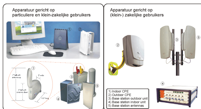
Figuur 2-9: BWA-systemen voorzien in breedband toegang voor vaste, nomadische en mobiele gebruikers
