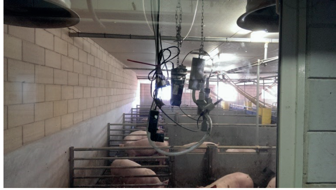
Meetopstelling met meetkoppen voor PM10 en Dusttrack. De losse meetkop links op de linker foto is de 'veldblanco' voor het bepalen van de endotoxinen. Hierdoor wordt geen lucht aangezogen.
