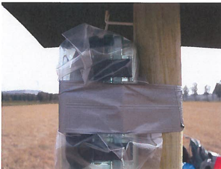
Figuur 4. Verpakking, bevestiging en bescherming van de magneetveldmeters tijdens de veldmeting (toelichting zie tekst)
