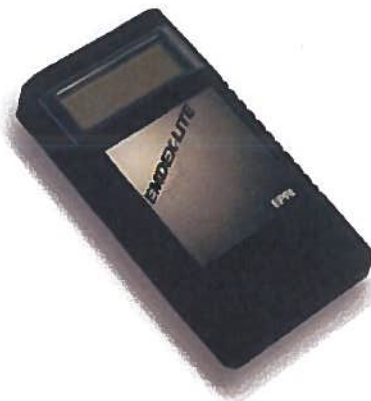
Figuur 3. De EMDEX Lite magneetveldmeter
