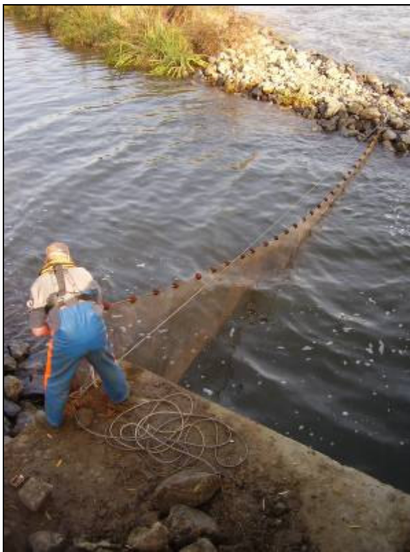
Figuur 12. Plaatsen van keernet bij inzwemopening bekkenvistrap
