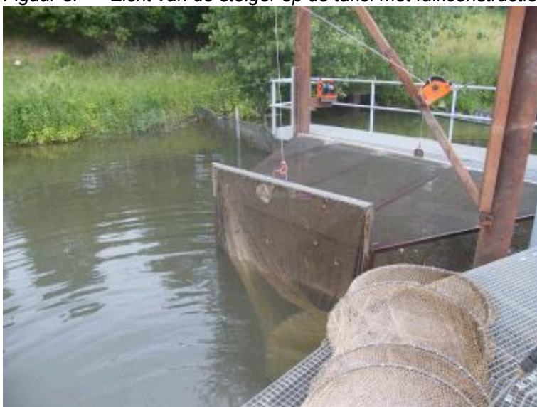
Figuur 8. Zicht van de steiger op de takel met fuikconstructie van de hevelvistrap.
