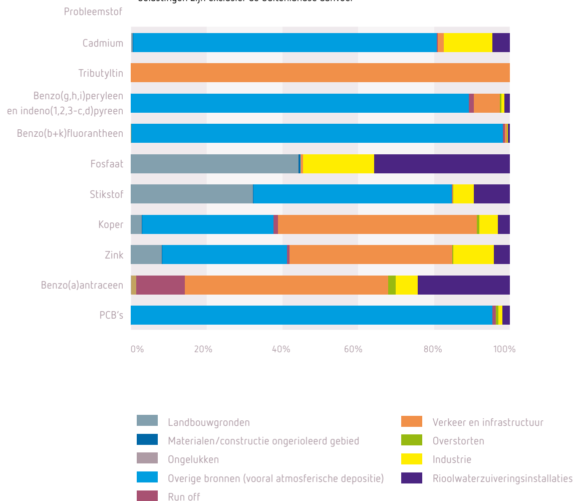
Figuur 5-1 Aandeel puntbronnen en diffuse bronnen voor enkele veel voorkomende normoverschrijdende stoffen in het stroomgebied Schelde (peiljaar 2006). De relatieve belastingen zijn exclusief de buitenlandse aanvoer
