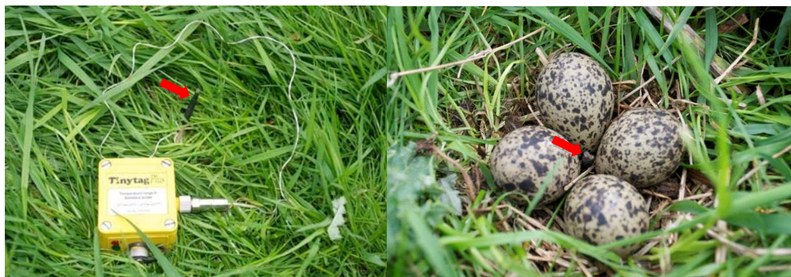
Figuur 3.1. De linker afbeelding laat een datalogger zien die middels de witte draad verbonden is met een temperatuursensor. Deze sensor wordt op een prikker bevestigd en in het midden tussen de eieren geplaatst (afbeelding rechts). De Logger en draad worden verborgen onder het maaiveld. Op beide afbeeldingen is de sensor aangeduid met een rode pijl.
