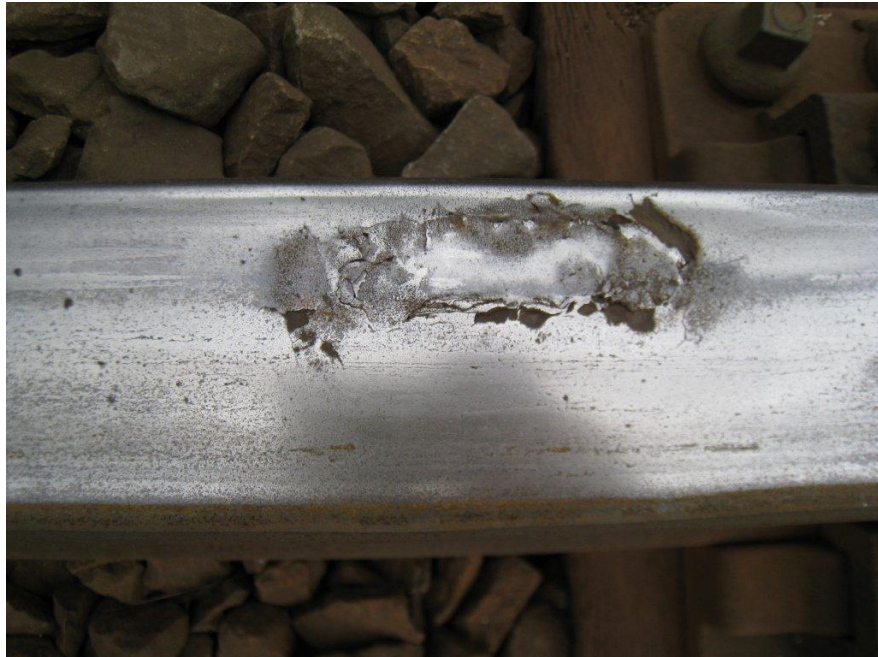
Figuur 2. Foto van Squat, type C, emplacement Waalhaven Zuid.
