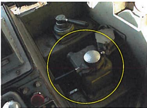
Foto 6. Oerlikon remkraan met drie remstanden L, M, H.
