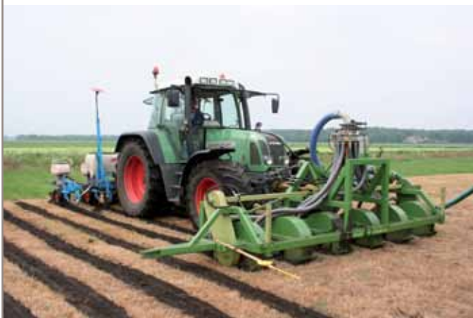
De Polfree, een rijenfrees die snijmaïs in een bestaande graszode zaait.
