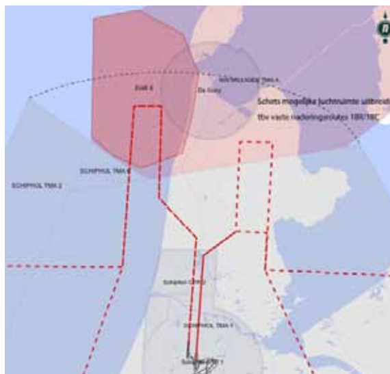
Figuur 14: Schets van het luchttruimbegrip van een ontwerp voor CDO's via vaste naderingsroutes op Schiphol bij landen op 18R+18C.
