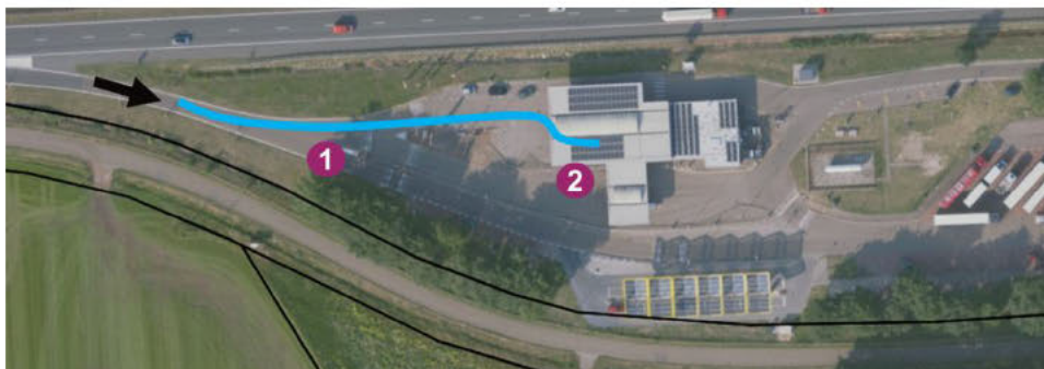
Figuur 6 Bovenanozicht route naar laadpunten Circle K met verkeersveiligheidsrisico's 1) bebording en 2) slechte zichtbaarheid van laadpunten
