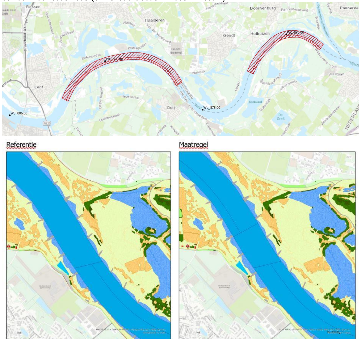
Figuur C.11: Schematisatie van de langsdammen. Boven: trajecten waarin de ruwheid is aangepast. Onder: overgangsgedieden waarin de ruwheid niet is aangepast.
