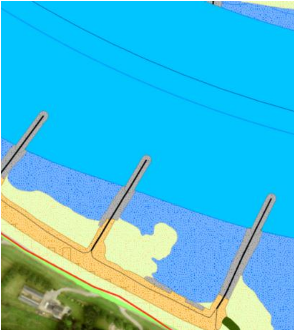
Figuur 5-10: Rivierversmalling middels kribverlenging.
