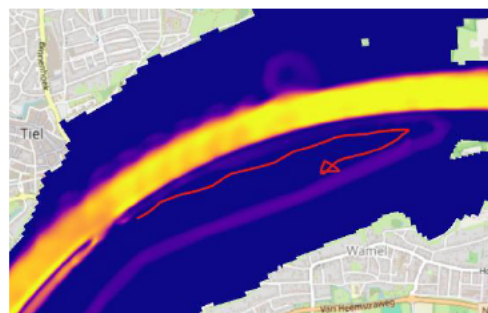
Figuur A-1. Stroomsnelheden in de UG-variant, 1300 m 3 /s.
