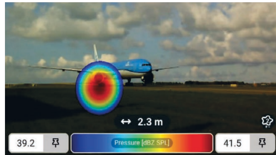
Figuur 11: Met behulp van de akoestische camera is te zien is dat de rechtermotor van het vliegtuig aanstaat.
