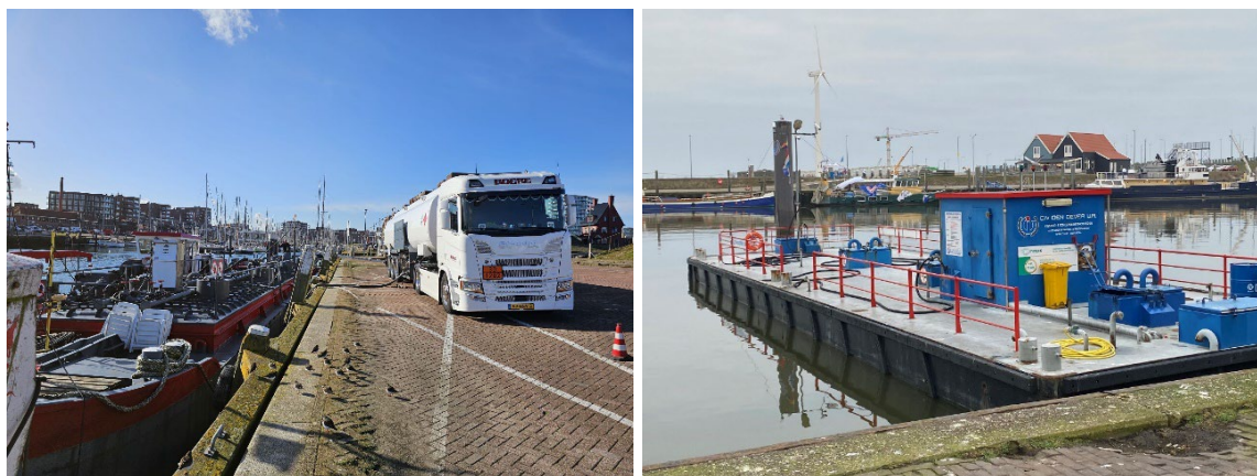
Figuur 4 Bunkerboot, tankauto (foto links) en bunkerponton (foto rechts)
