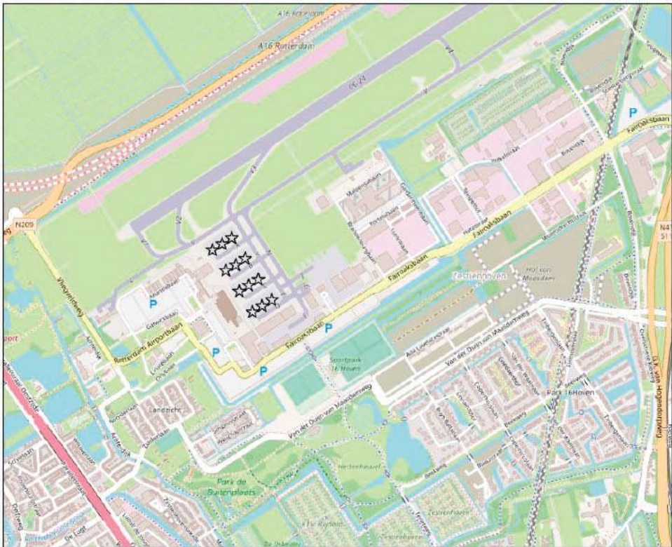
Figuur 15: Gebruikte APU-emissielocaties op Rotterdam The Hague Airport. APU-locaties zijn gemarkeerd met een ster
