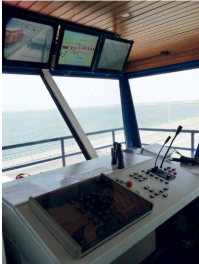
Figuur 4: De Bedienconsole met rechts de reguliere bediening en links, afgeschermd, de noodbediening
