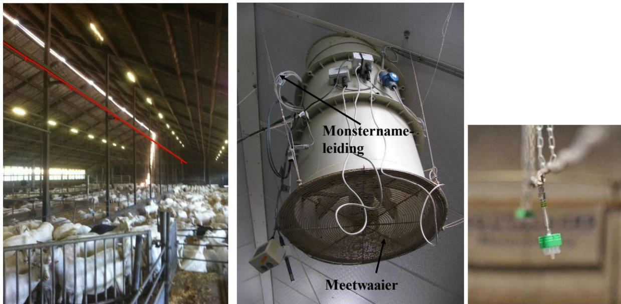
Figuur 3.1 Meetopstelling met monsternamelleiding. Links: voorbeeld in een natuurlijk geventileerde geitenstal. Midden: voorbeeld in een mechanisch geventileerde stal; Rechts: voorbeeld van monsternamelpunt met kritische opening en stoffilter.
