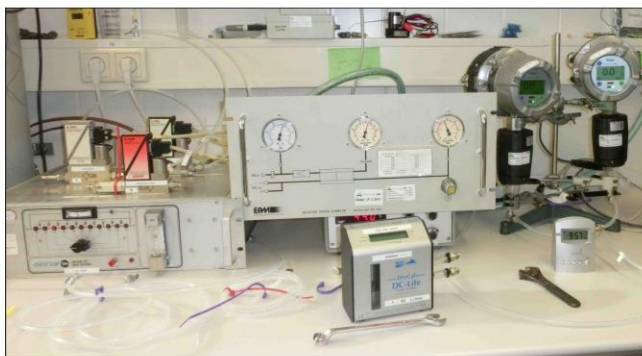
Figuur 3.3 Links: Meetopstelling voor de kalibratie van NH 3 Dräger-sensoren in het Air Quality Laboratorium (AQL) van Wageningen Livestock Research (WLR). Rechts: voorbeeld regressielijn (labkalibratie) voor één van de NH 3 Dräger-sensoren.
