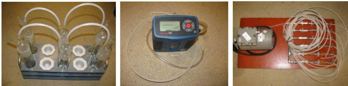
Figuur A2 Meetopstelling WLR voor NH 3 - protocolaire metingen. Links: wasflessen. Midden: Droge gasstroommeter (DryCal® Defender 510-m, Bios Int. Corp, VS). Rechts: pomp (Thomas Industries Inc., model 617CD32, Wabasha, Minnesota, VS), monsternameleiding (teflon of polyethyleen) en kritische openingen (borosilicaatglas (diameter: 8 mm; lengte: 80 mm), gehuisvest in a roestvrijstaal container voor bescherming).
