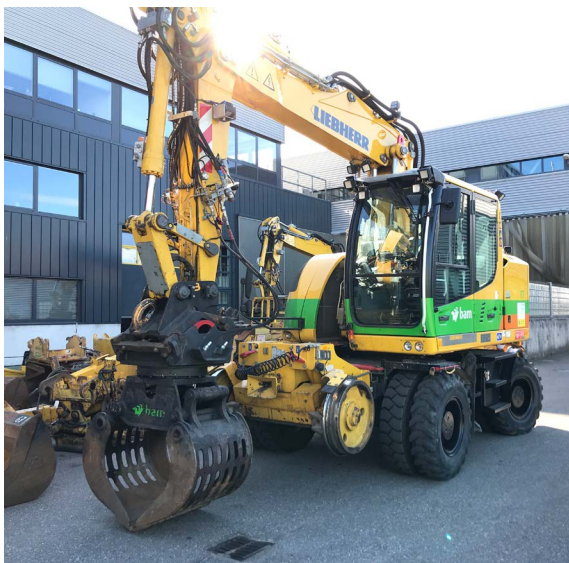
◀ Figuur 41: Voorbeeld van een kraan op lorries met sorteerknijper (foto: BAM).
