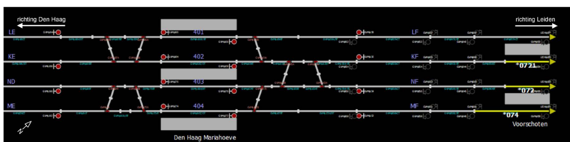
▲ Figuur 54: Fragment uit applicatie TOON waarmee spoorbezettingen (gele lijnen) gevisualiseerd kunnen worden. Dit fragment (01.45 uur) laat de sporen (witte lijnen) zien tussen station Den Haag Mariahoeve en Voorschoten. Op spoor 1 (LF) is geen spoorbezetting zichtbaar bij station Voorschoten, op spoor 2 (KF, *0721), spoor 3 (NF, *072) en spoor 4 (MF, *074) zijn spoorbezettingen zichtbaar. (bron: ProRail)
