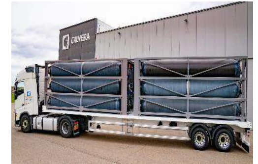
Figuur 8.4: Transportwagen voor het vervoeren van gasvormige waterstof
