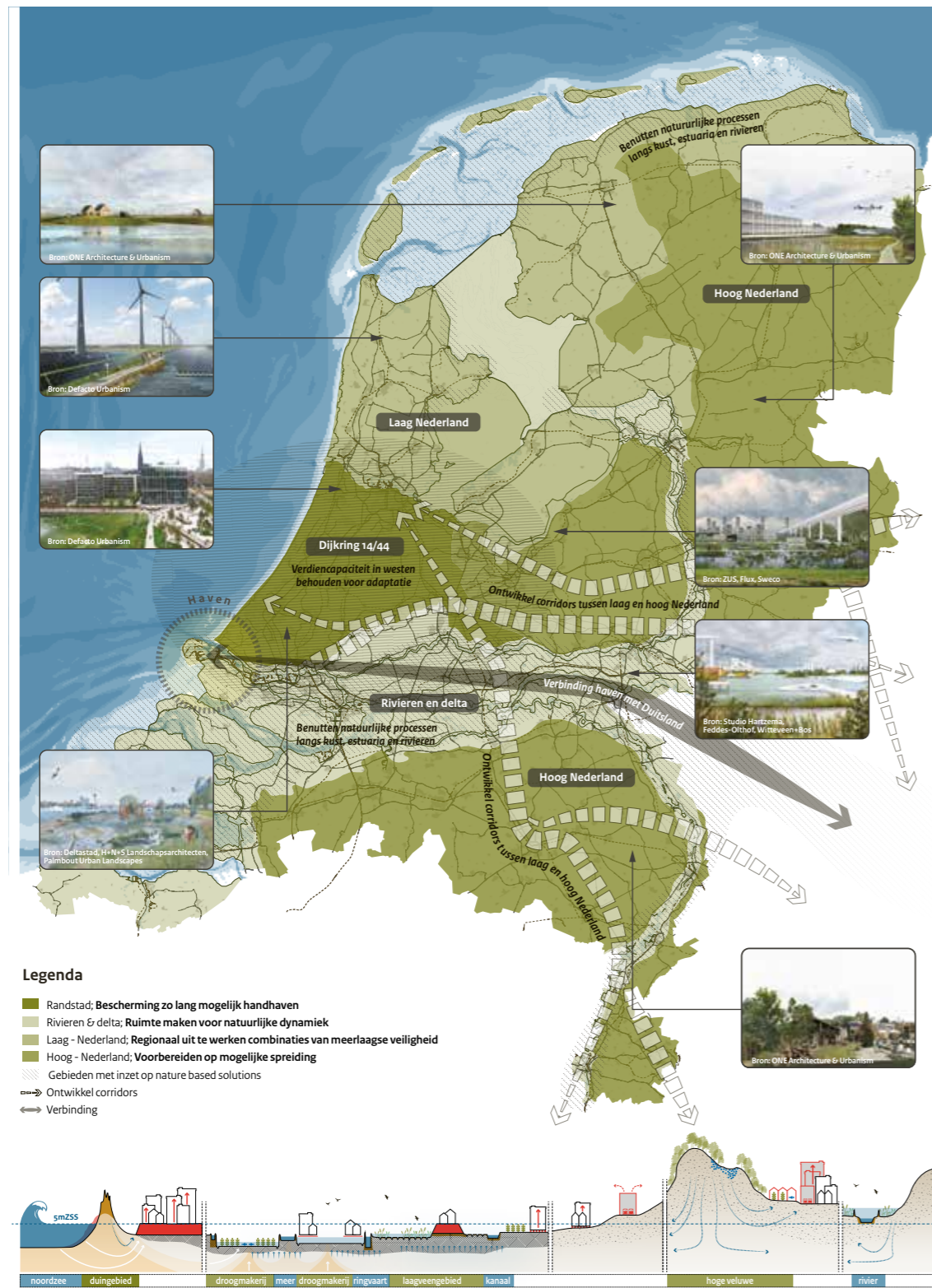
Figuur 2: Landschappelijke impressies (beelden in de kaart) en bouwstenen (dwarsprofiel) van de denkrichting Meebewegen. In de kaart wordt grafweg onderscheid gemaakt tussen de overstromingsgevoelige gebieden in Nederland en de hogere delen. In de overstromingsgevoelige gebieden zijn binnen de denkrichting Meebewegen aanpassingen nodig aan bebouwing en landgebruik die de kwetsbaarheid van het gebied verkleinen. Het gebied van dijkkring 14 en 44 is onderscheiden, omdat naar aanleiding van een nadere analyse geconcludeerd is dat dit gebied zo lang mogelijk beschermd moet blijven met dijken en duinen om het verdienvermogen van Nederland op peil te houden.
