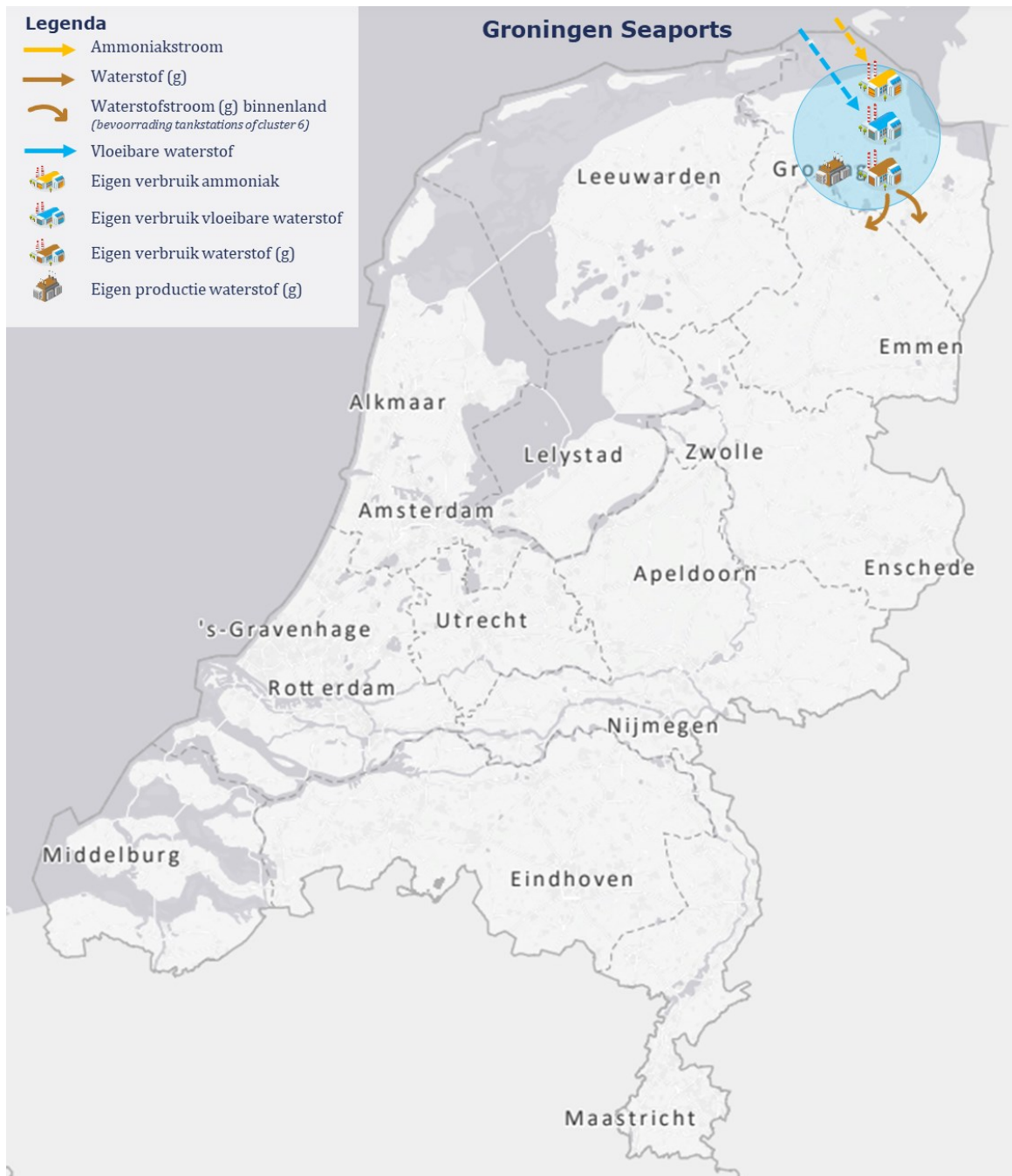
Figuur 26. Schematische weergave van stromen naar en van Groningen Seaports.
