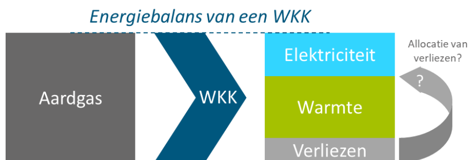
Figuur 3.1: Energiebalans van een WKK-installatie, betreft allocatie van verliezen over eindproducten (elektriciteit en warmte)
