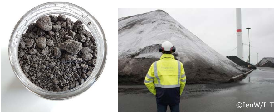
Figuur 2.1 Thermisch gereinigde grond van dichtbij en in depot.
