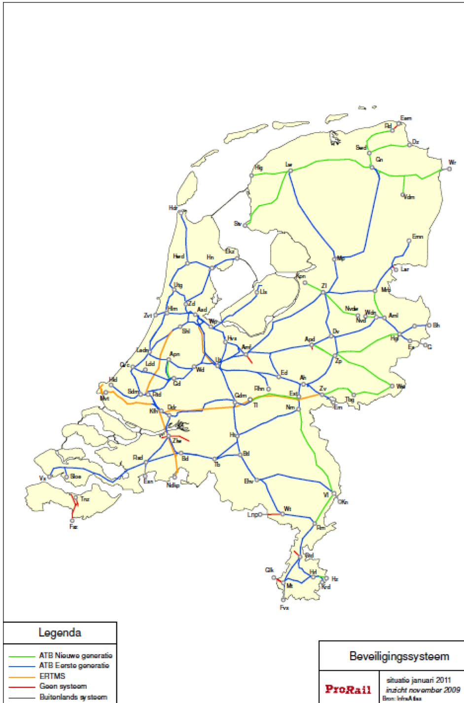
Figuur 19 Geïnstalleerde sein- en treinbeïnvloedingssystemen, ATB lijnen zijn met het NS'54 seinstelsel (bron: Netwerkverklaring 2011)
